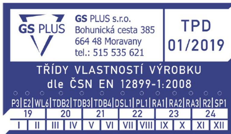
Obr. 11.5.1 - Příklad štítku na zadní straně návěstidla
