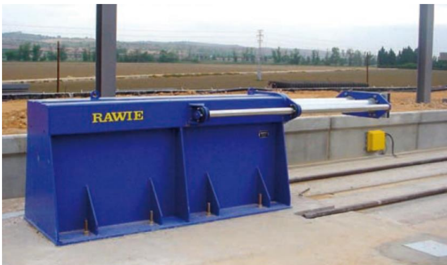
Obr. 8.3.4.1 - Příklad pevného zarážedla s hydraulickými nárazníky výrobce RAWIE
