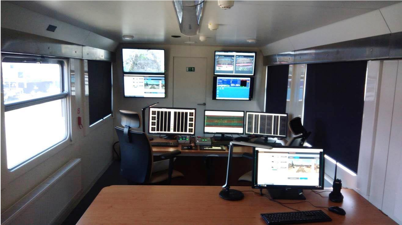
Obr. 7.5.6 Pracoviště operátorů ovládajících měřící systémy, lokalizaci jednotky v trati a sběr dat.
