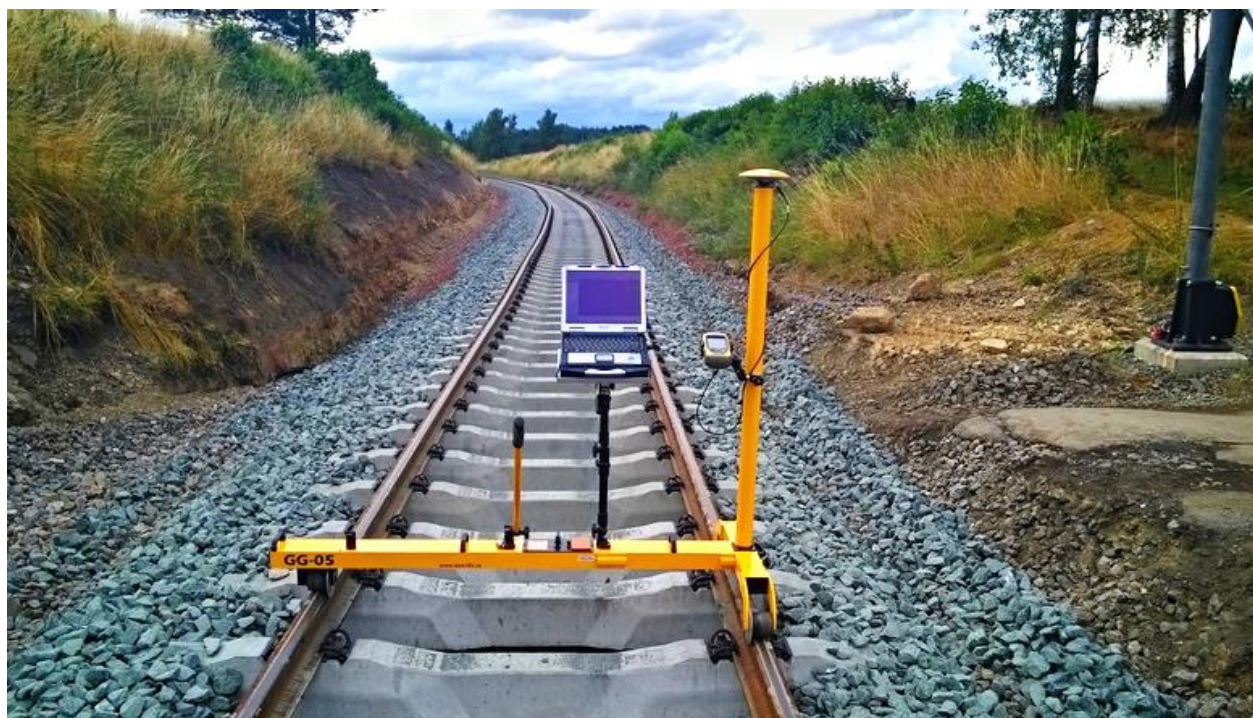
Obr. 2.3.4.6 – Měřicí vozík osazený aparaturou pro měření technologií GNSS
