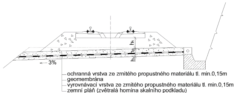
Obr. 3.7.6 - Příklad použití geomembrány
