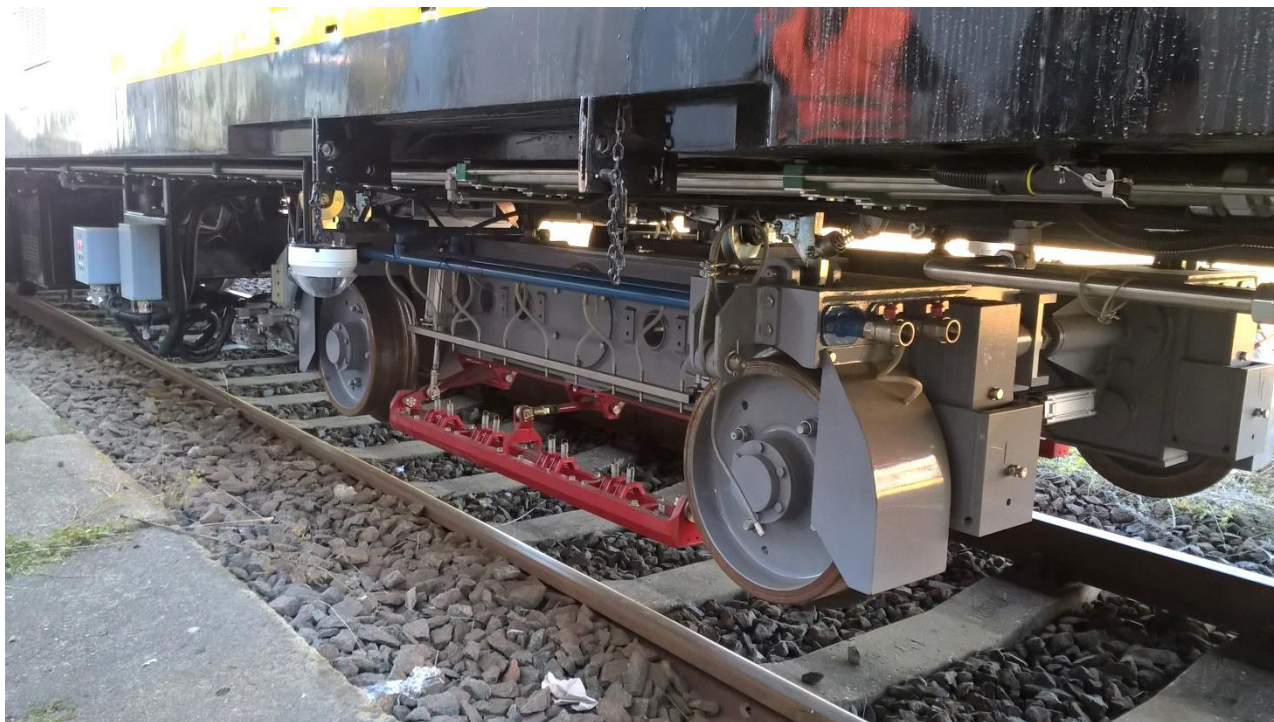
Obr. 7.5.5 Snímače UT a ET jsou umístěny na měřícím podvozku, který zabezpečuje kontinuální měření.
