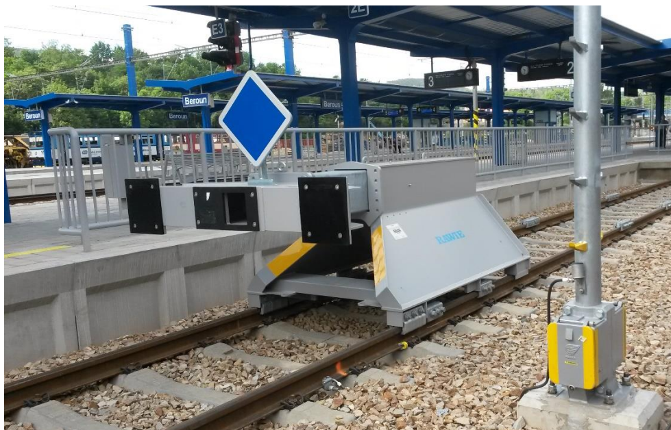
Obr. 8.3.4.3 - Příklad pohyblivého zarážedla s hydraulickými nárazníky, středním nárazníkem a přidavnými brzdami výrobce RAWIE
