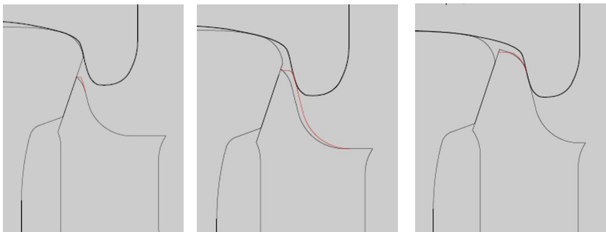
Obr. 4.6.2.2.5 Princip zesílení profilu jazyka.
