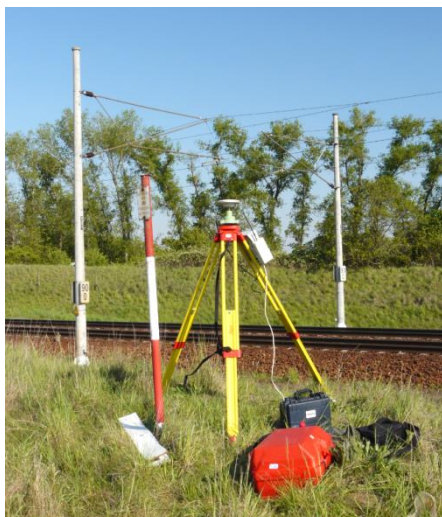
Obr. 2.3.1.6a – Měření GNSS na bodě ŽBP
