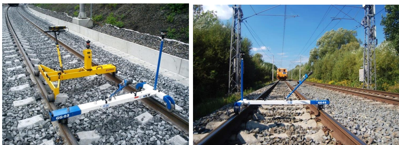
Obr. 2.3.4.3 – Měřicí vozík GRP 3000 fy Amberg a GG-03 fy GeoTEL
