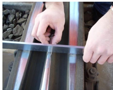
Obr. 4.6.6.3 Měření opotřebení srdcovky
