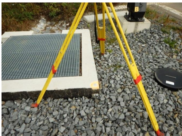
Obr. 2.3.1.2 – Bod primární sítě ŽBP stabilizovaný měřickým hřebem
