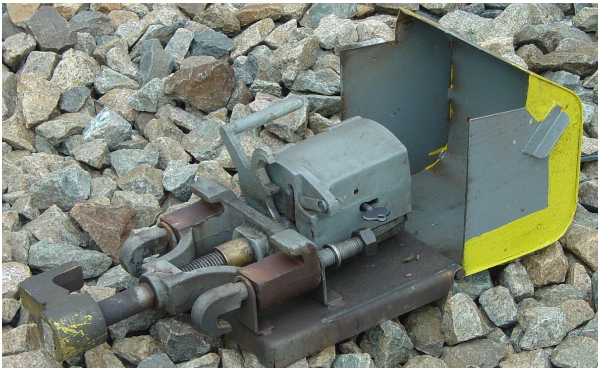
Obr. 4.6.4.2.3 Odtlačný zámek – pohled na vnitřní uspořádání (výměnový zámek se liší tvarem háku zámku)
