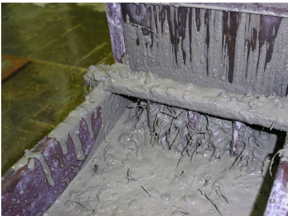
(8) Obr. 8 – Zkouška SCC L-truhlíkem – nesprávně navržená směs, blokace při použití nevhodné délky ocelových vláken
