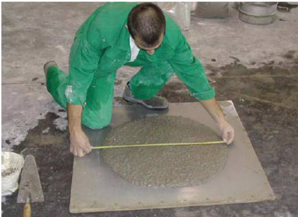
(3) Obr. 3 – Zkouška rozlití SCC - správně navržená směs
