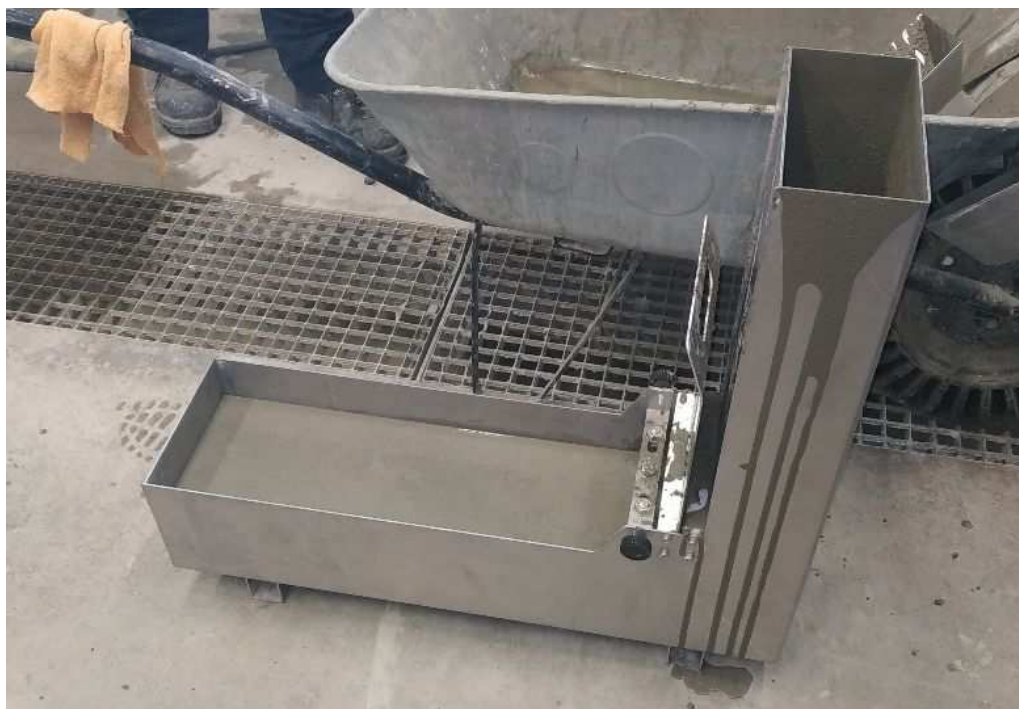
(9) Obr. 9 – Zkouška SCC L-trušíkem – nesprávně navržená směs, vysoká náchylnost k bleedingu a segregaci (na povrchu pouze cementové mléko bez kameniva)
